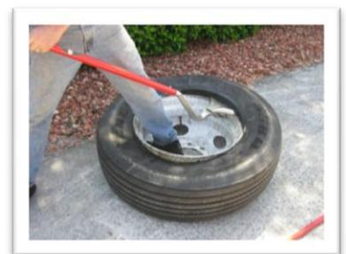
4. Vuelva a llevar la palanca hasta la posición inicial para acabar de separar el neumático. Repita el movimiento para acabar de separar el neumático completamente.
