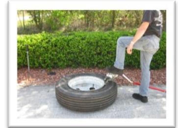
2. Inserte la herramienta entre el neumático y la llanta.
