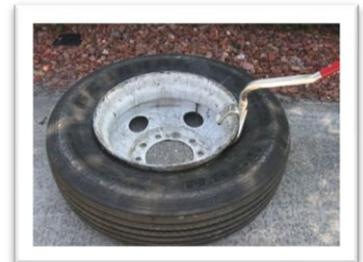
3. Lleve la palanca hacia la parte opuesta del neumático, separando así el neumático de la llanta.
